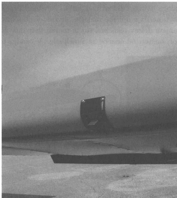
Slika 16. Indikator kritičnega naletnega kota na naletnem delu krila
