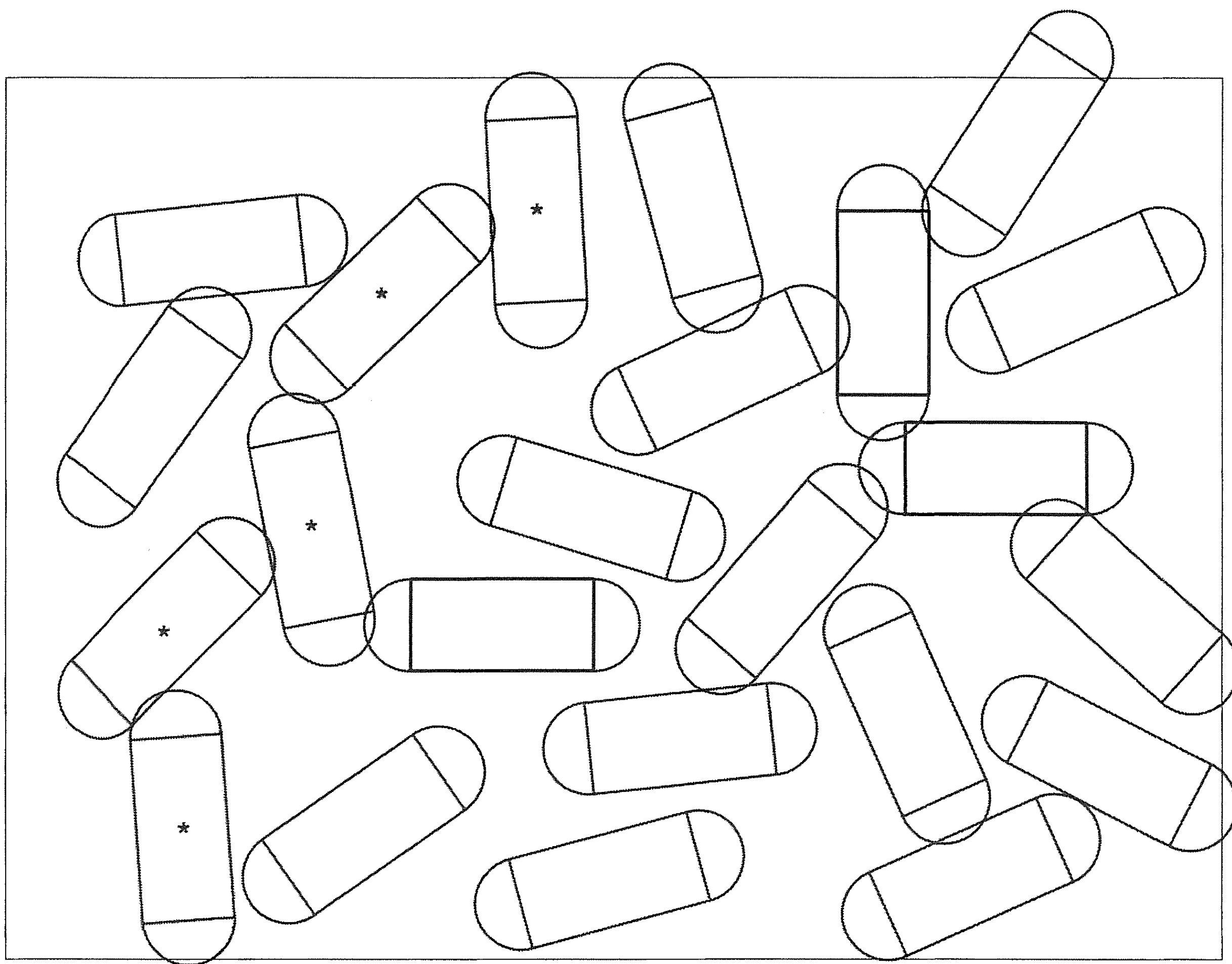
Slika 4. Shematski dvorazsežni prikaz doseženega perkolacijskega praga za paličaste delce. Skupina delcev s prevodno potjo je označena z zvezdicami.
