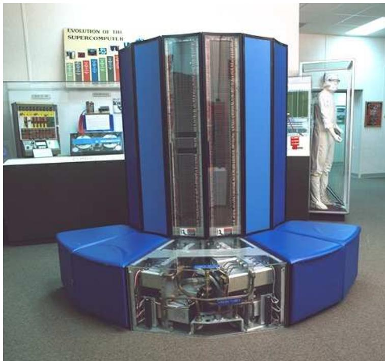
Superračunalnik Cray XMP-24 je predelani XMP-22 - prvi komercialni superračunalnik, v uporabi od 1983 do 1993, za svoje čase najhitrejši: 420 milijonov operacij na sekundo.
