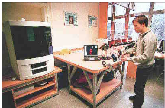
Na levo je »titanski« Stratsys Dimension 3D, na desni pa laserski 3D skener Kreon Zephyr KZ50 na petosni mehanski roki Faro Gold Arm (Med laserskim modeliranjem kavljav).
