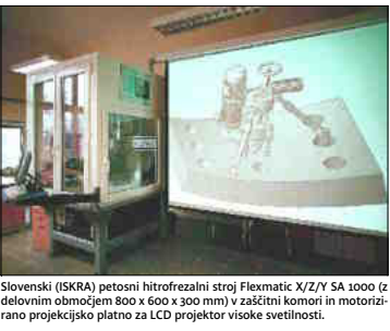
Slovenski (SKRA) petosni hitrorezalni stroji Flexmatic X/Z/Y SA 1000 (z delovnim območjem 800 x 600 x 300 mm) v zaščiteni kabini in motorizirano projekcijsko platno za LCD projektor visoke svetlosti.
